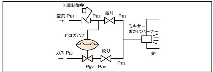
ゼロガバナにより絞りの入口側ガス圧力 $P_{g2}$ と空気圧力 $P_{a2}$ とを等しくして混合比を一定に保てます。
