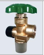
5~120リットルのアルミ容器に使用します。 電解腐食を防ぐため、ネック部に錫メッキを施しています。
